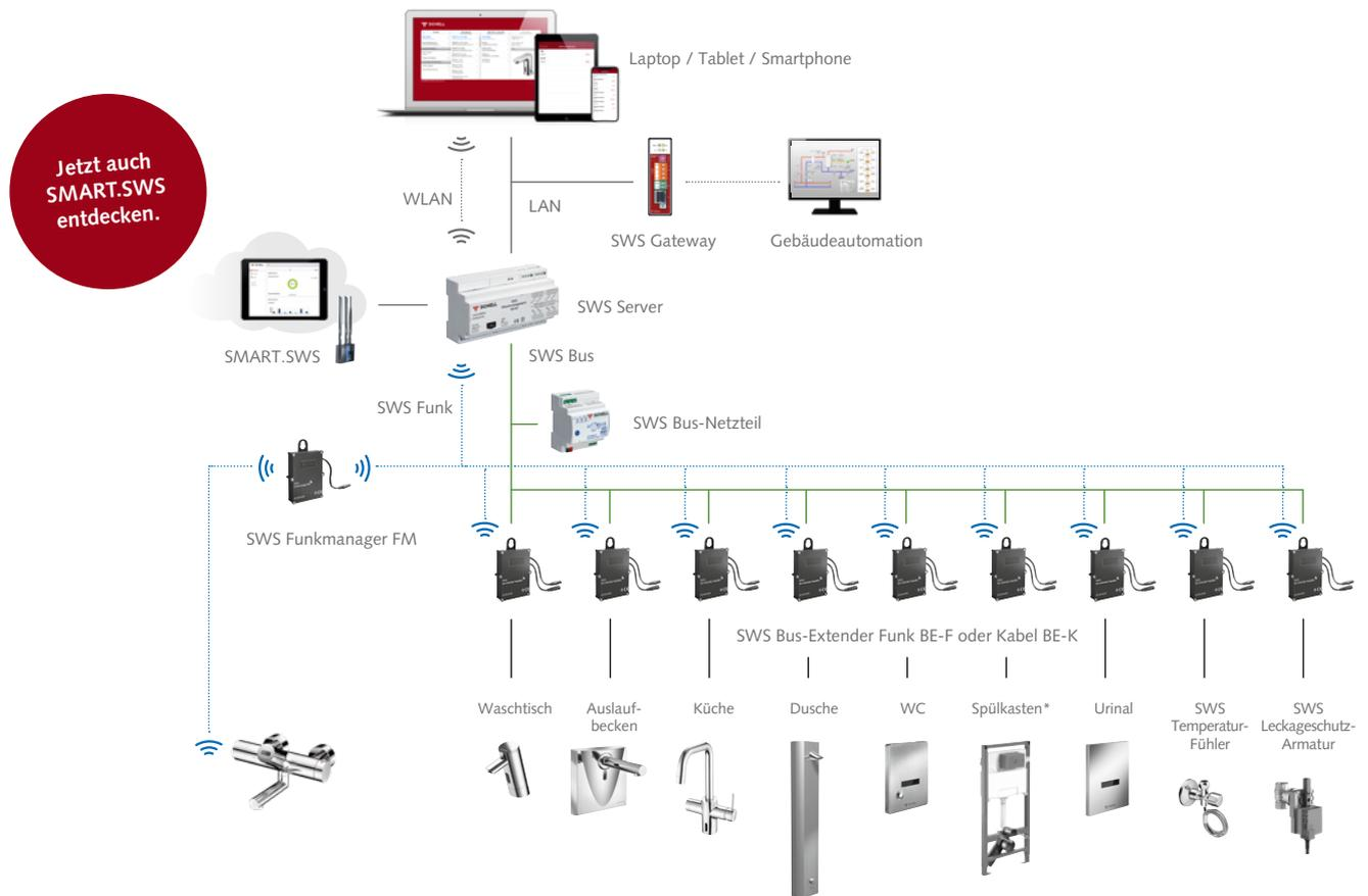
\*SWS Bus-Extender Funk BE-F Flow oder Bus-Extender Kabel BE-K Flow
